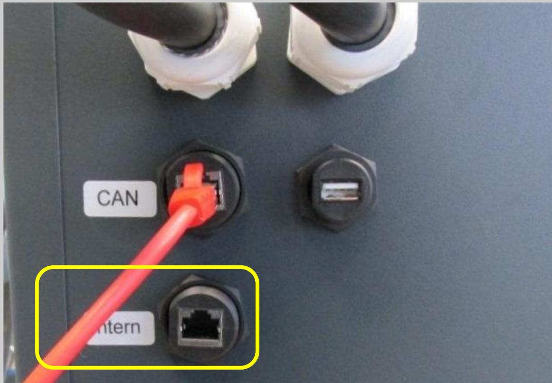
*Abbildung Darstellung der externen Anschlüsse des Batteriesystems*
