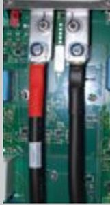
Abbildung Beispielhafte Darstellung des Anschluss der Leistungsleitungen Plus und Minus am Wechselrichter SMA Sunny Island
