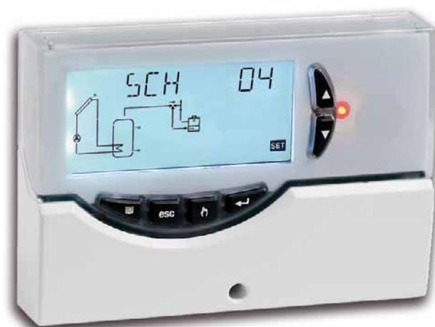
Regolatore differenziale a microprocessore per impianti solari: compara le temperature dei fluidi nel collettore e nei serbatoi di accumulo e, se differiscono più del DeltaT, attiva lo scambio di calore tramite la pompa. 3 ingressi per sonde di temperatura tipo NTC, 2 uscite on-off a relé SPST, 1 uscita ausiliaria per allarme a relé SPDT. Termostati di integrazione per gestire le fonti di calore ausiliarie. Visualizzazione di tutte le temperature. Parametri contestuali allo schema scelto.
